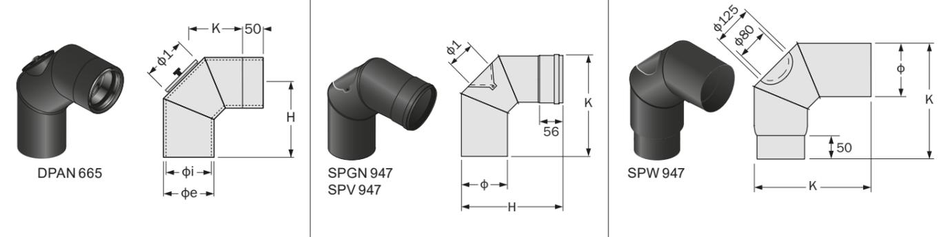
**Curva orientabile T200** Possibilità di regolazione da 0° a 90°, con guarnizioni silconiche di tenuta nella giunzione dei settori. Funzionamento in (regolazione 0+90°) pressione positiva P1, max 200°C.
