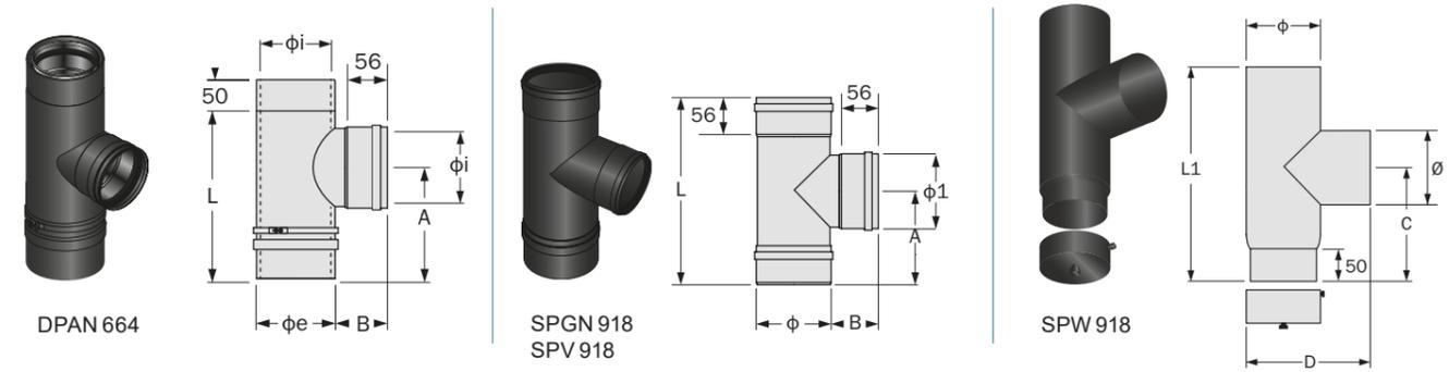
T 90° F-M con tappo Raccordo a T 90° completo di tappo raccolta condensa e incombusti. È sempre consigliato di impiegarlo come elemento di partenza per lo scarico fumi posteriore di una stufa a pellet. Elemento con innesto superiore femmina (F) e innesto laterale maschio (M). Il collegamento tra il raccordo a T90° e il tappo di raccolta condensa è bloccato tramite fascetta di giunzione.
