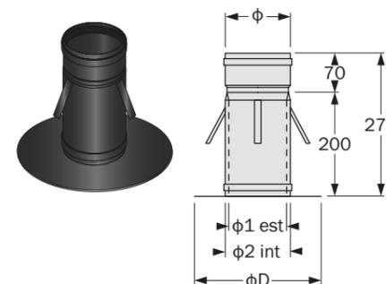
**Adattatore M-M prolungato** Nel caso di installazioni degli elementi della serie SPGN-SPV con l'innesto femmina verso l'alto, l'adattatore M-M (maschio-maschio) prolungato consente il collegamento del raccordo telescopico a soffitto (SPGN 980) agli elementi SPGN-SPV sottostanti.
