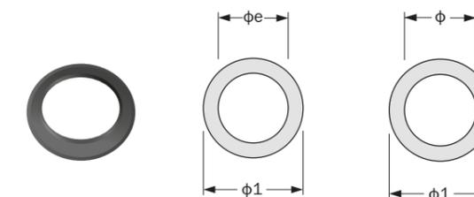
**Rosone di finitura per innesto a muro 45°** L'elemento ha la funzione estetica di coprire il foro di attraversamento nel muro. Utilizzare il rosone nei casi di innesto a muro a 45° con il lato maschio dell'elemento attraversante.
