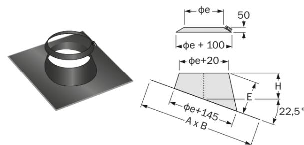
**Scossalina** Applicata sulla parete esterna del sistema camino, contribuisce a garantire un'ottima tenuta alle infiltrazioni di acqua piovana nei casi di attraversamento di tetti.
