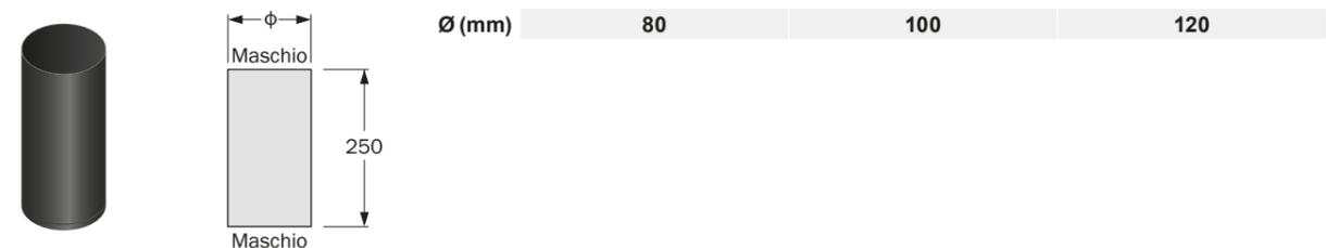
**Moldulo controllo fumi** È dotato di manicotto per permettere il controllo dei fumi secondo le norme vigenti (Ø 1/2"). Idoneo per funzionamento in pressione positiva P1.
